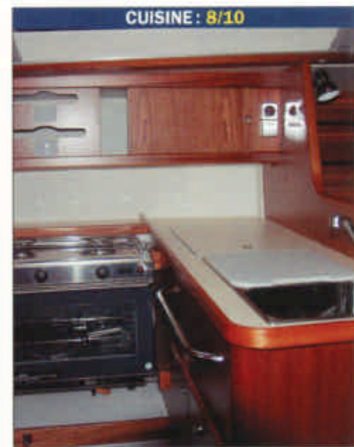
Disposée en «L», la cuisine comporte un évier à deux bacs, une glacière de 40 litres et une gazinière inox deux feux avec four. Le vaisselier, tout juste assez grand, est complété par trois tiroirs et un grand placard sous l'évier.
