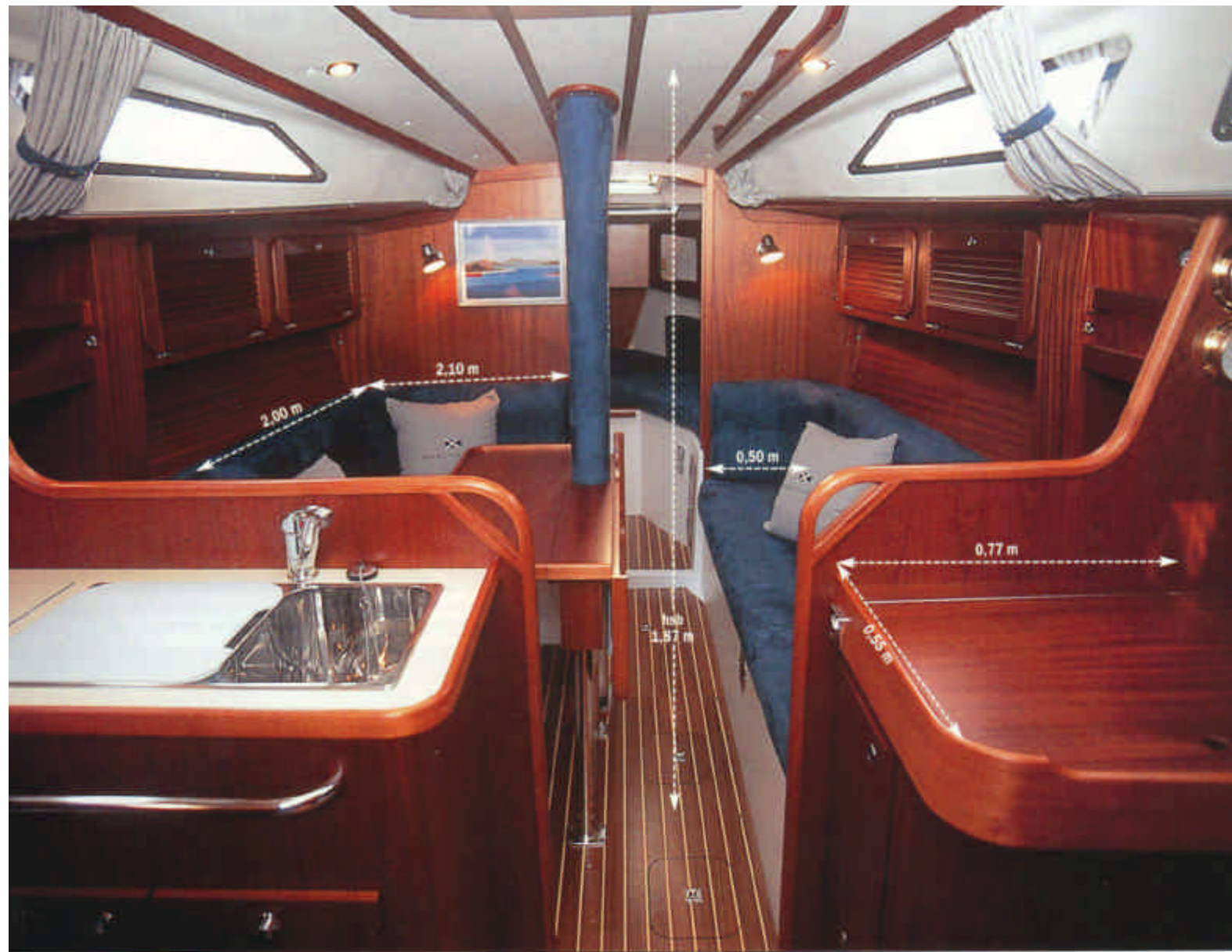
Disposition classique pour ce carré, avec deux banquettes en vis-à-vis et une table à rabats (1,10 x 0,80 mètre) qui permet d'ouvrir le passage vers la cabine avant. Cette table peut être retirée pour alléger les poids en course. La banquette
